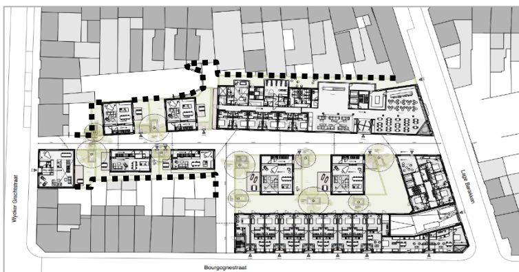
Figuur 11 De locaties waar een erfafscheiding met adequate geluidwering noodzakelijk wordt geacht, geborgd in het bestemmingsplan
